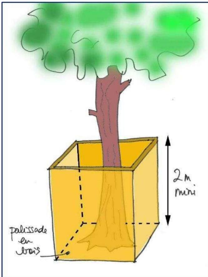
Dans le cas d'un chantier dont la durée dépasse 2 semaines, une protection spécifique pourra être demandée pour certains arbres. Cette protection sera constituée d'une enceinte de 2 à 4 m<sup>2</sup>, formée d'une palissade en bois de 2 m minimum de hauteur.
